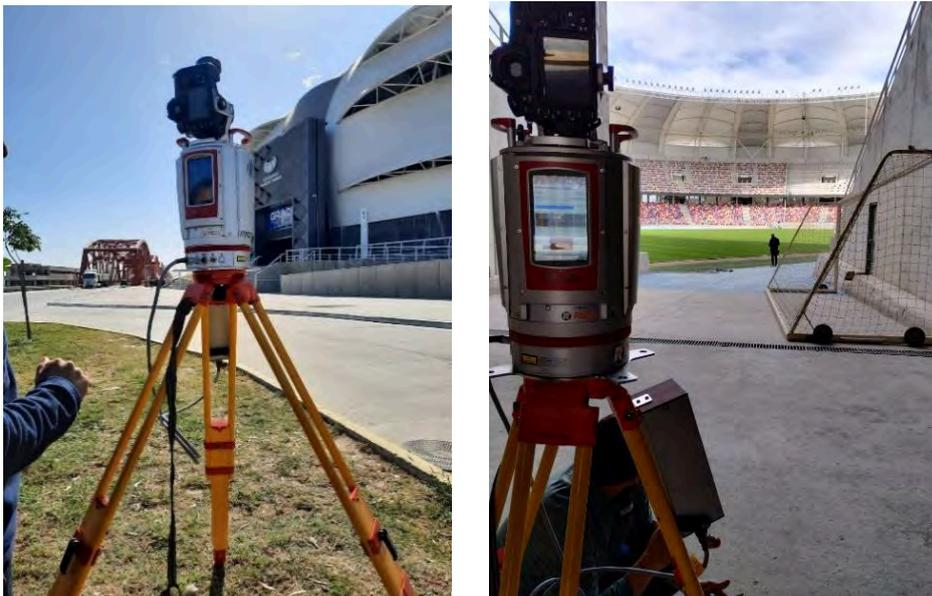
Figura 2: Escáner 3D RIEGL VZ-400i
